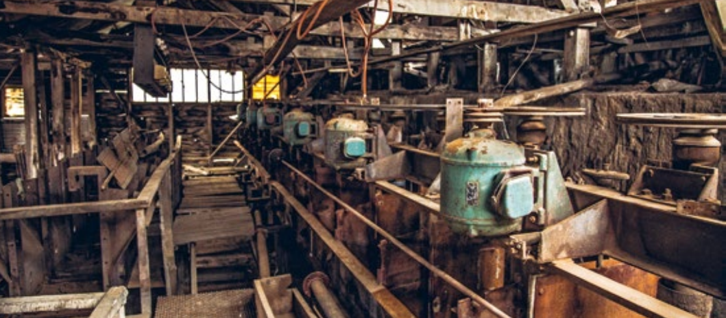
Celdas de flotación | Flotating cells
