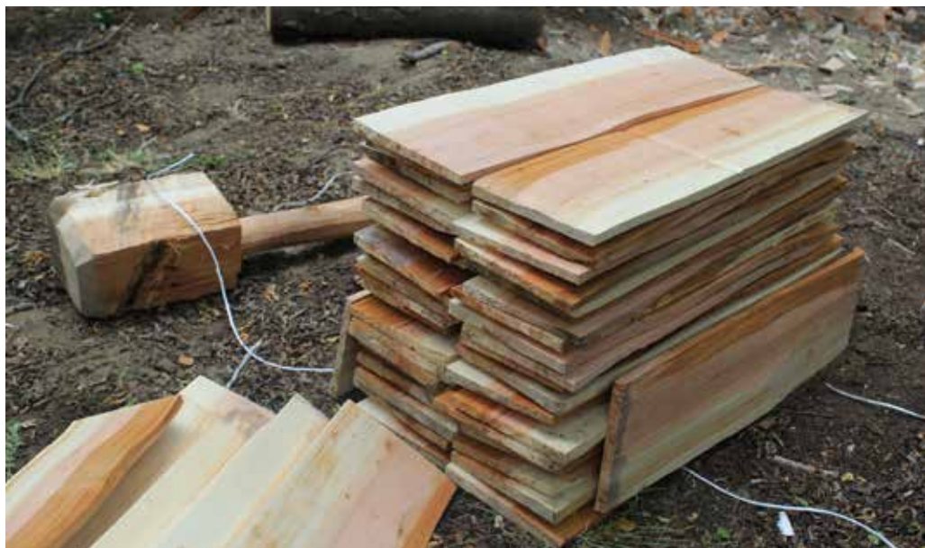
Figura 21. Tejuela artesanal de lenga ( N. pumilio ) de largo estándar (22 pulgadas) y ancho que va entre 4 ½ a 6 pulgadas de ancho, y espesor sobre los 6 mm.
