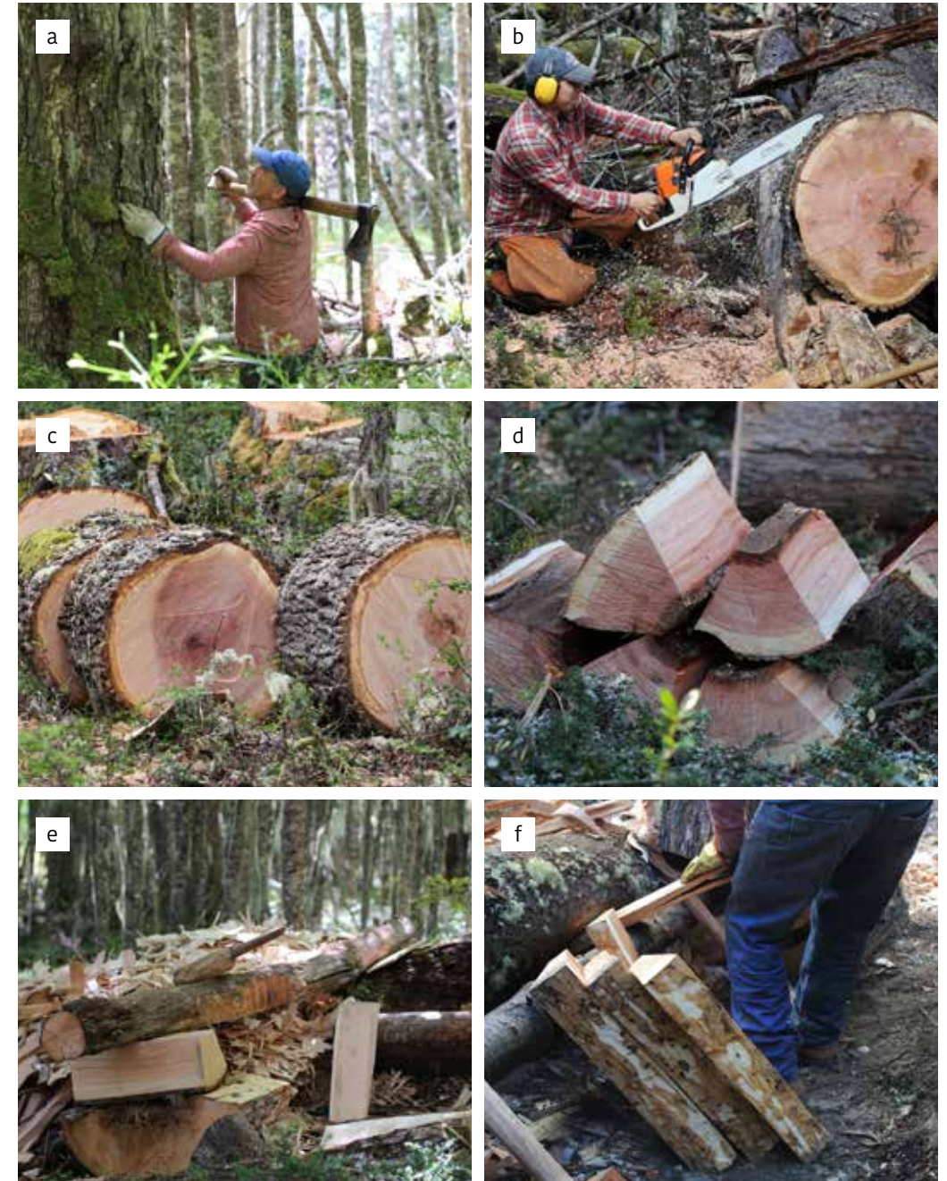
Figura 18. Diferentes etapas existentes en la elaboración de la tejuela artesanal de lenga ( N. pumilio ), región de Aysén: a) Selección árbol; bcd) Volteo, trozado y metaneado; efg) partida y labrado; hij) Amarrado y encastillado; kl) Hombreo al interior del bosque; m) traslado tejuelas en carro tirado por bueyes; nop) Traslado tejuelas desde el bosque hacia el lugar de uso definitivo, construcción.
