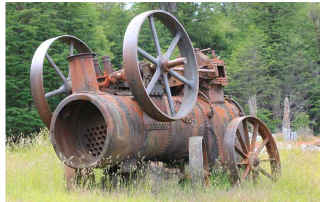
Figura 32. Locomóviles (motores a vapor), tecnología de aserrío introducida a la región de Aysén desde 1935 en adelante. Maquinaria que se extendió por todo el territorio aysenino y funcionó hasta principios de la década de 1970. Sector la Leonera-Puerto Guadal, comuna de Chile Chico y Predio La Gloria, comuna de Coyhaique, región de Aysén.
