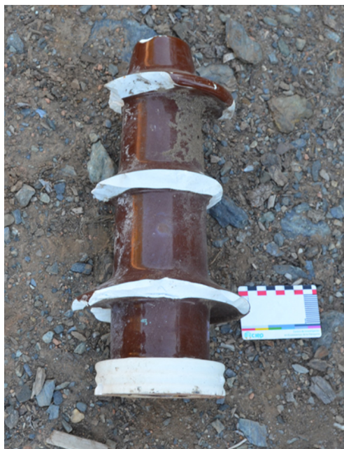
ATSLADOR DE LOZA VIDRIADA HALLADO EN SUPERFICIE EN MINA ESCONDIDA. SE UTILIZABA PARA PERMITIR EL PASO DEL CABLE QUE CONDUCE LA ELECTRICIDAD, POR LOS POSTES, PERO SIN TOCARLOS. MINA ESCONDIDA, PUERTO GUADAL, REGIÓN DE AYSÉN 2024. FOTOGRAFÍA: JAVIERA LETELIER COSMELLI.
